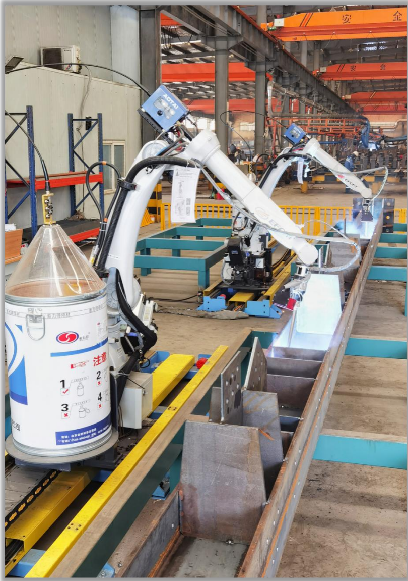
◀ 6米、9米地轨移动式焊接机器人 ▶ 6미터, 9미터 지상 레일 이동식 용접 로봇 6-meter, 9-meter Floor Rail Mobile Welding Robot
