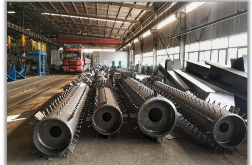
◀ 钢管柱制作现场 ▶ 강관 칼럼 제작 현장 Steel Pipe Column Manufacturing Site
